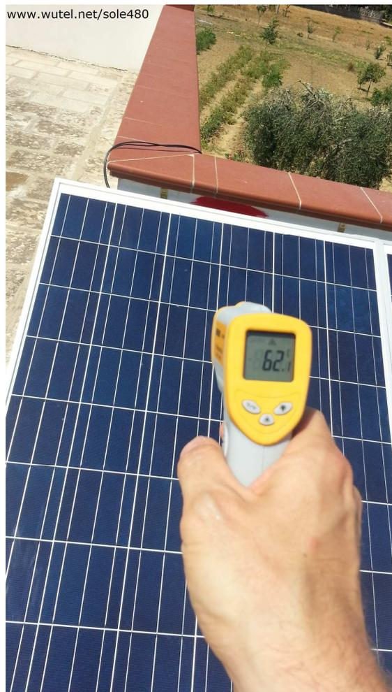
Se fattibile, occorre quindi installare i pannelli il più possibile distanziati dalla superficie di fissaggio, in modo da permettere sempre un adeguato flusso d'aria per il loro raffreddamento.
